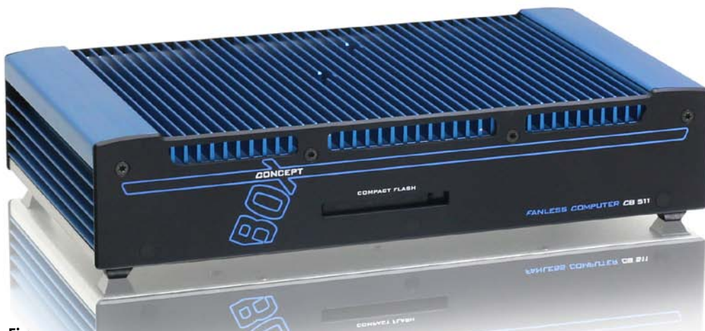
Figur 7 Helt enligt SFF-trenden: Denna box-PC ur Kontrons CB-serie (i detta fall CB 511) erbjuder både en SSD och interna eller externa kortplatser för CompactFlash-kort (här externa). Så de kan lagra operativsystemdata mycket säkert och under lång tid, eftersom dessa data endast skrivs om vid förändring av konfigurationen. Om SSD-enheten för swap- och tillämpningsdata skulle falla p.g.a. sidfel eller spänningsbortfall kan systemen som regel boota om utan någon aktion från användaren.
