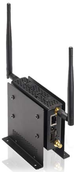
Figur 8 Kontron M2M Smart Services Development Kit är en kompakt plattform med hög tillgänglighet avsedd för utveckling av M2M-tillämpningar. Den integrerar ett 4 Gigabyte MicroSD-kort för M2M smart-servicetillämpningar, middleware samt ett operativsystem. Integration av ytterligare en minnelösning rekommenderas för tillämpningar som regelbundet behöver lagra stora mängder information.
