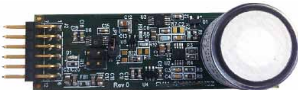
Analog Devices CNO357, en lågbrusig gasdetektor som drivs med en enda matningsspänning. Genom att använda elektromekaniska sensor med programmerbar förstärkning går det snabbt att ta fram prototyper.
