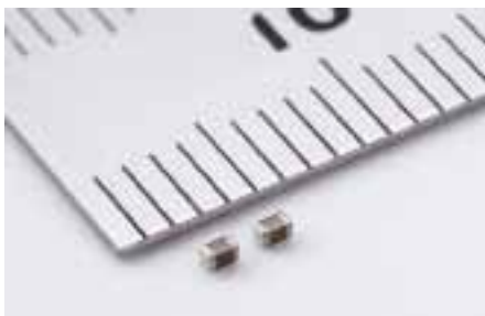
0603 (0,6 x 0,3 mm) är den populäraste kapseln, men 0402 växer snabbt och 0201 tycks ha framtiden för sig.
